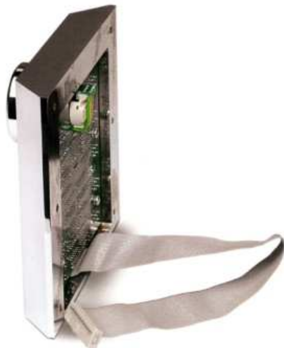
Das Display sitzt in einem 25 Millimeter starken Aluminiumblock
