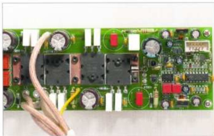
Hier fand man eine Möglichkeit, auch die großen Leistungstransistoren wegsparend auf der Platine unterzubringen
